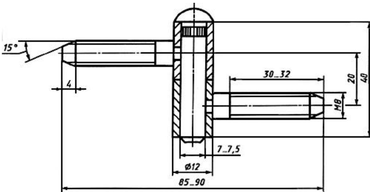
Рисунок Б.21 - Пример ввертной петли типа ПВв2
