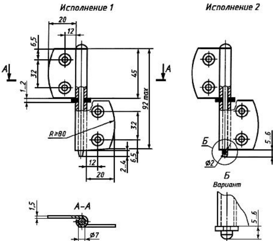
Рисунок Б.10 - Пример накладной петли типа ПН7
