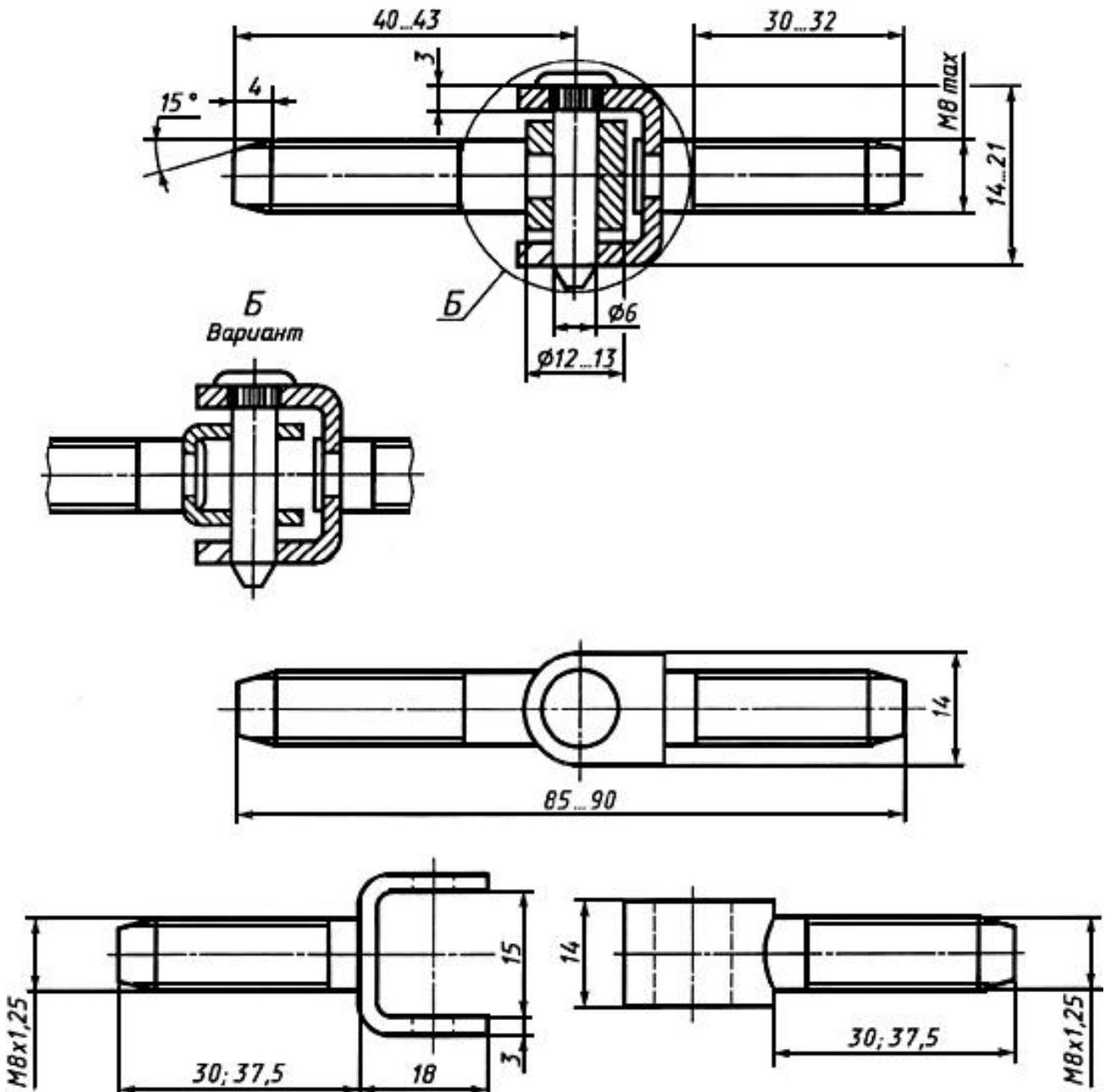
Рисунок Б.20 - Пример ввертной петли типа ПВв1
