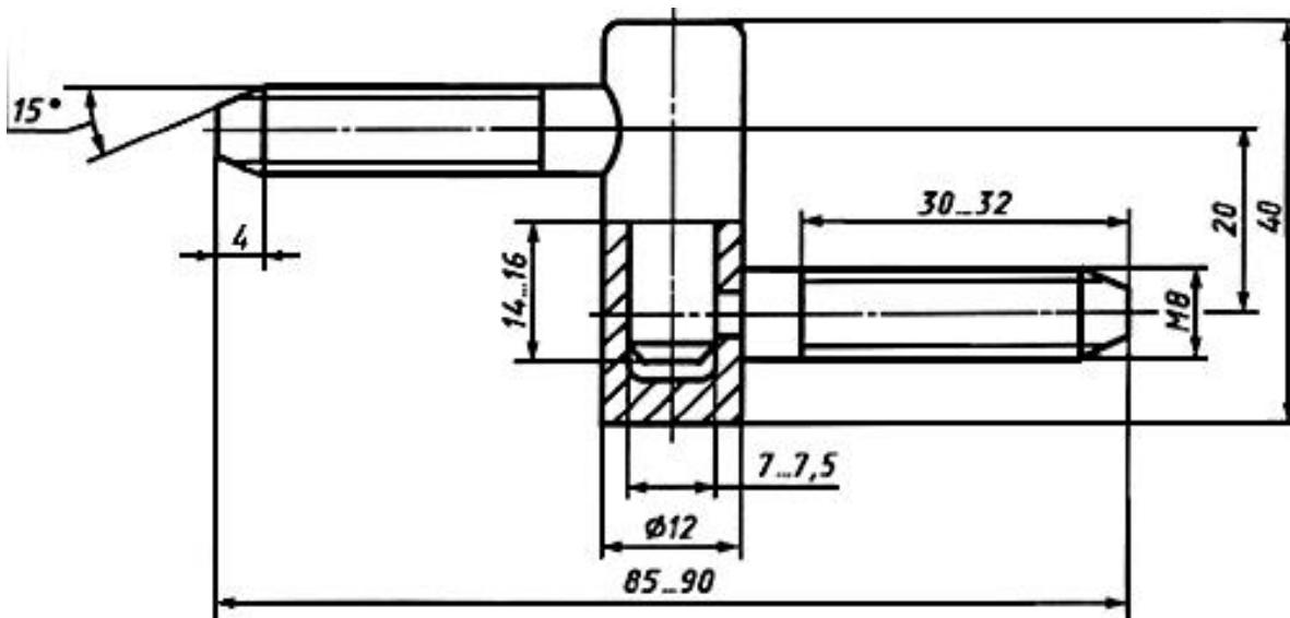
Рисунок Б.22 - Пример ввертной петли типа ПВв3
