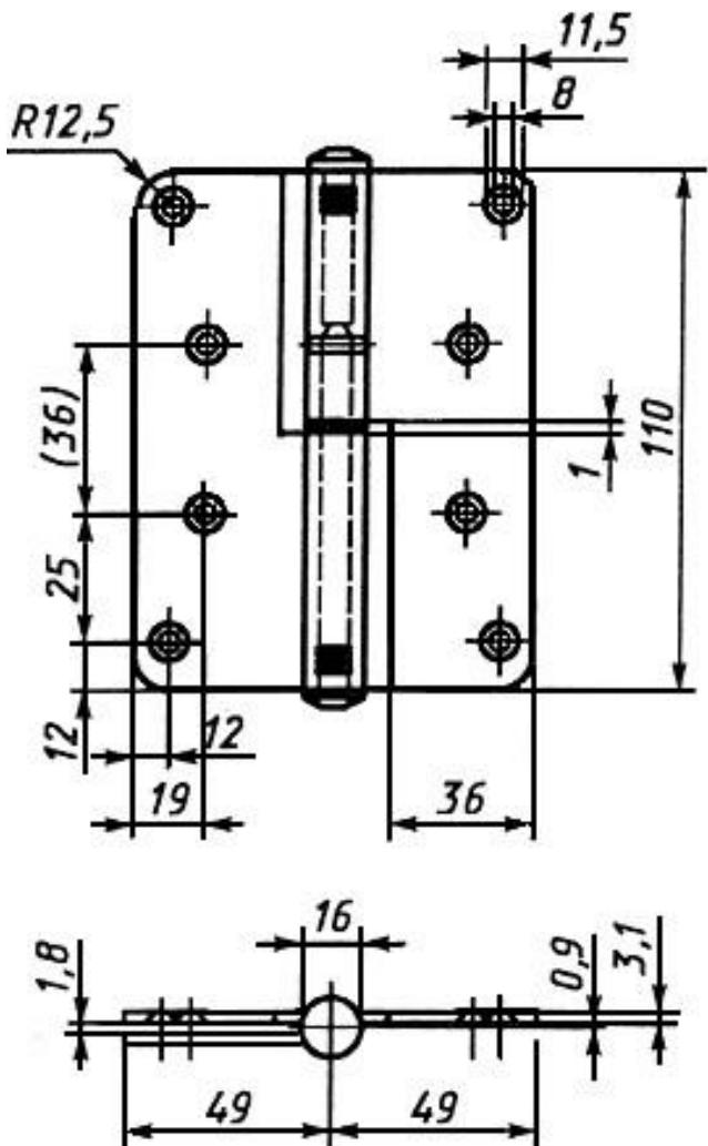
Рисунок Б.2 - Пример накладной петли типоразмера ПН1-110
