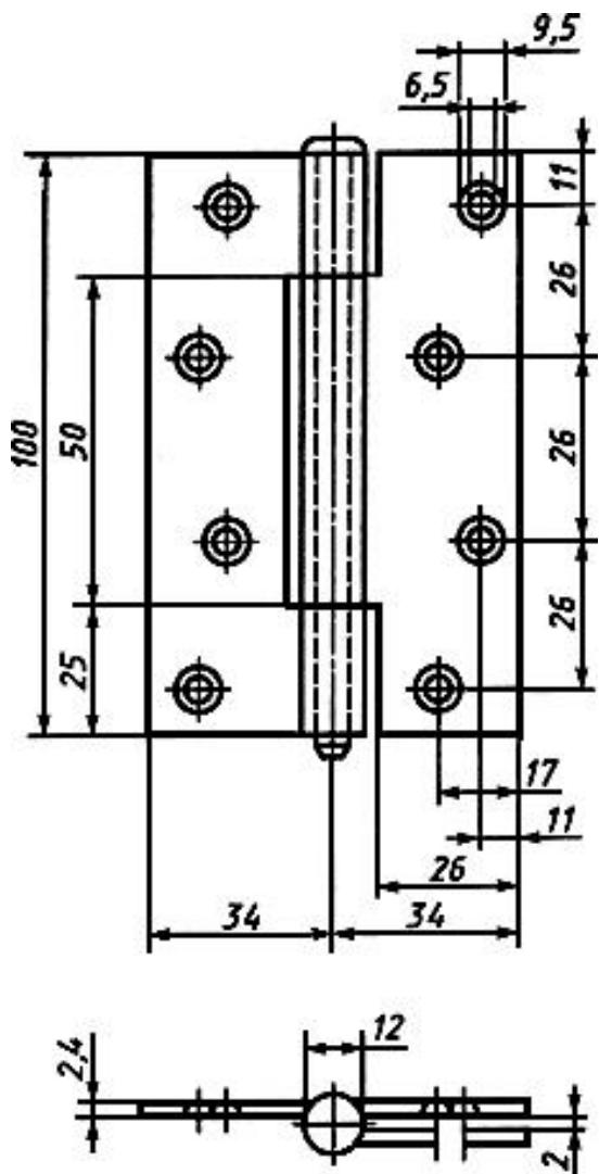
Рисунок Б.19 - Пример врезной петли типоразмера ПВ4-100
