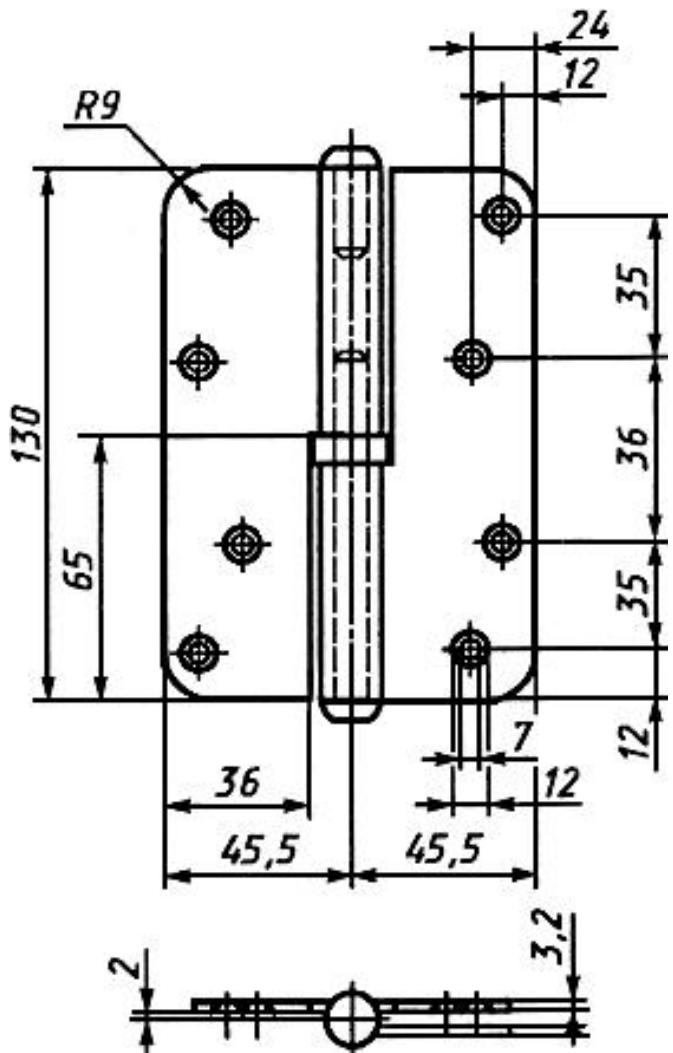
Рисунок Б.6 - Пример накладной петли типоразмера ПН3-130
