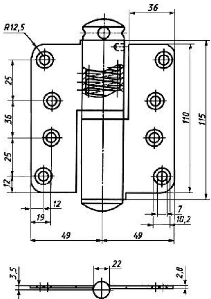
Рисунок Б.13 - Пример накладной петли типоразмера ПН-115
