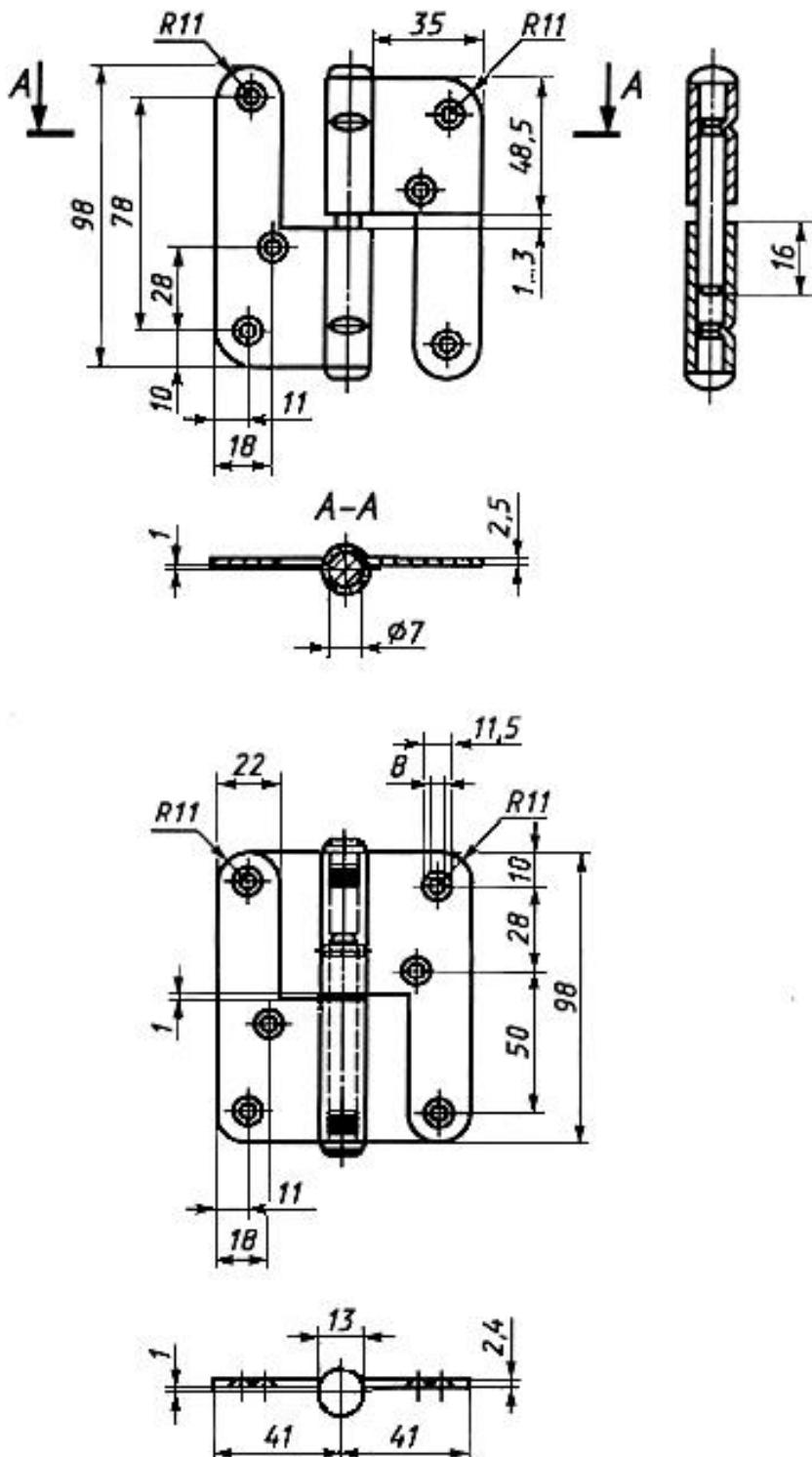
Рисунок Б.7 - Примеры накладной петли типа ПН4
