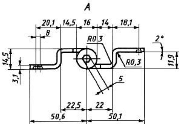
Рисунок Б.11 - Пример накладной петли типа ПН7 для дверных блоков из алюминиевых сплавов
